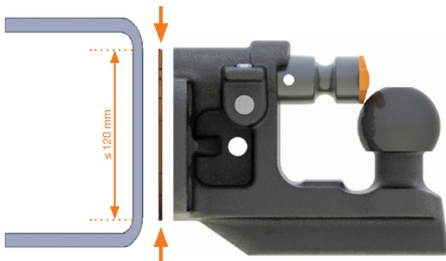
CROCHET EN VERSION À FERMETURE ASSISTÉE : SI LA FACE PLANE DE LA TRAVERSE EST ≤ 120 MM, UTILISER LA PLATINE T220 75 80 RECOUVRANT LA FACE ARRIÈRE DU CROCHET
